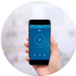
A Philips DDL709-FVP-7HWS fica on-line em tempo real por meio da conexão Wi-Fi. Após vincular o app da Philips, você pode visualizar o histórico de acesso à fechadura, enviar remotamente códigos PIN temporários e visualizar a situação em tempo real da porta clicando no botão de vídeo.
