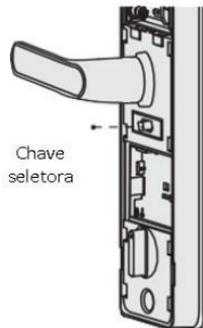
1. **Habilitar:** Mova a chave seletora da maçaneta de segurança para exibir a marca "vermelha". Assim que o habilitado, a maçaneta interna será travada.
